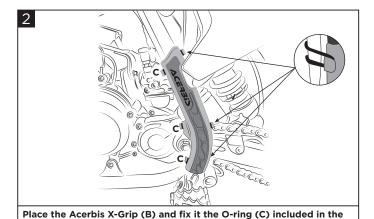
Posizionare X-Grip Acerbis (B) e fissarlo con gli O-ring (C) in dotazione.
